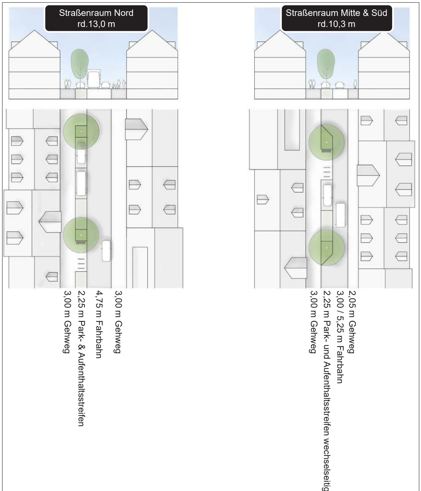
Abb. 162: Umgestaltung Von-Cölln-Straße - Querschnitte
